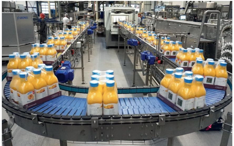
Abfüllanlage für Direktsäfte im neuen Werk der Firmengruppe Gropper in Stockach
