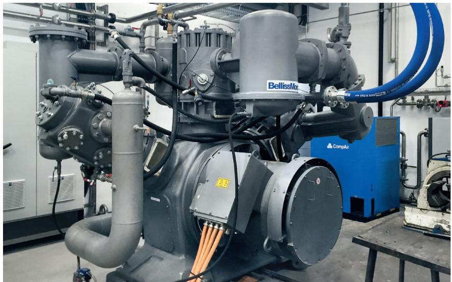
**Ölfrei arbeitender Kolbenkompressor vom Typ WH 29 3N mit schaftlosem 325kW-Motor, Direktantrieb und maximalem Volumenstrom von 1.800 m<sup>3</sup>/h (bei 40 bar)**
