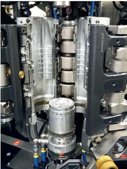
Daumengroßen Vorformlinge werden mit einem Druck von bis zu 40bar „aufgeblasen“.
