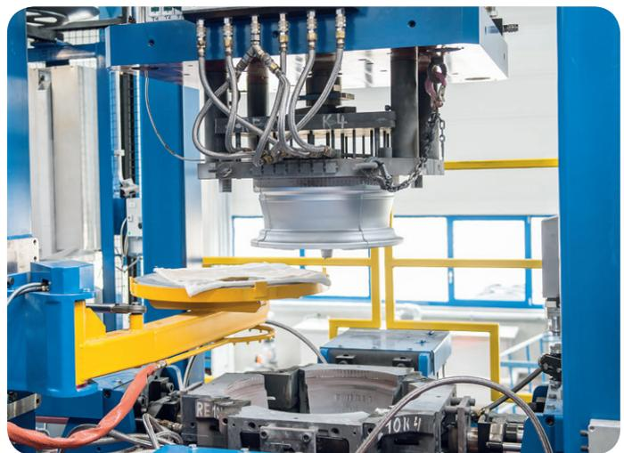
Im Niederdruckgussverfahren wird flüssiges Aluminium gleichmäßig und verwirbelungsfrei mit Überdruck unter Zuhilfenahme von Druckluft in eine Gussform gedrückt.
