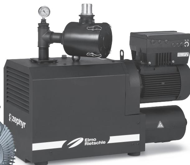
**Klauen-Vakuumpumpe C-VLR 301 mit frequenzgeregeltem IE3 Motor, Saugvermögen bis 370m<sup>3</sup>/h, Endvakuum im Dauerbetrieb 200 mbar (abs). Durch Sound Engineering konnte der Schalldruckpegel deutlich reduziert werden.**
