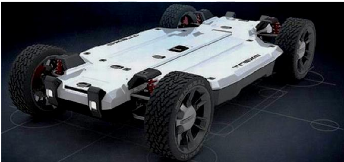
Abbildung 3: Konzept eines selbsttragenden E-Autochassis (Quelle: Trexa)
