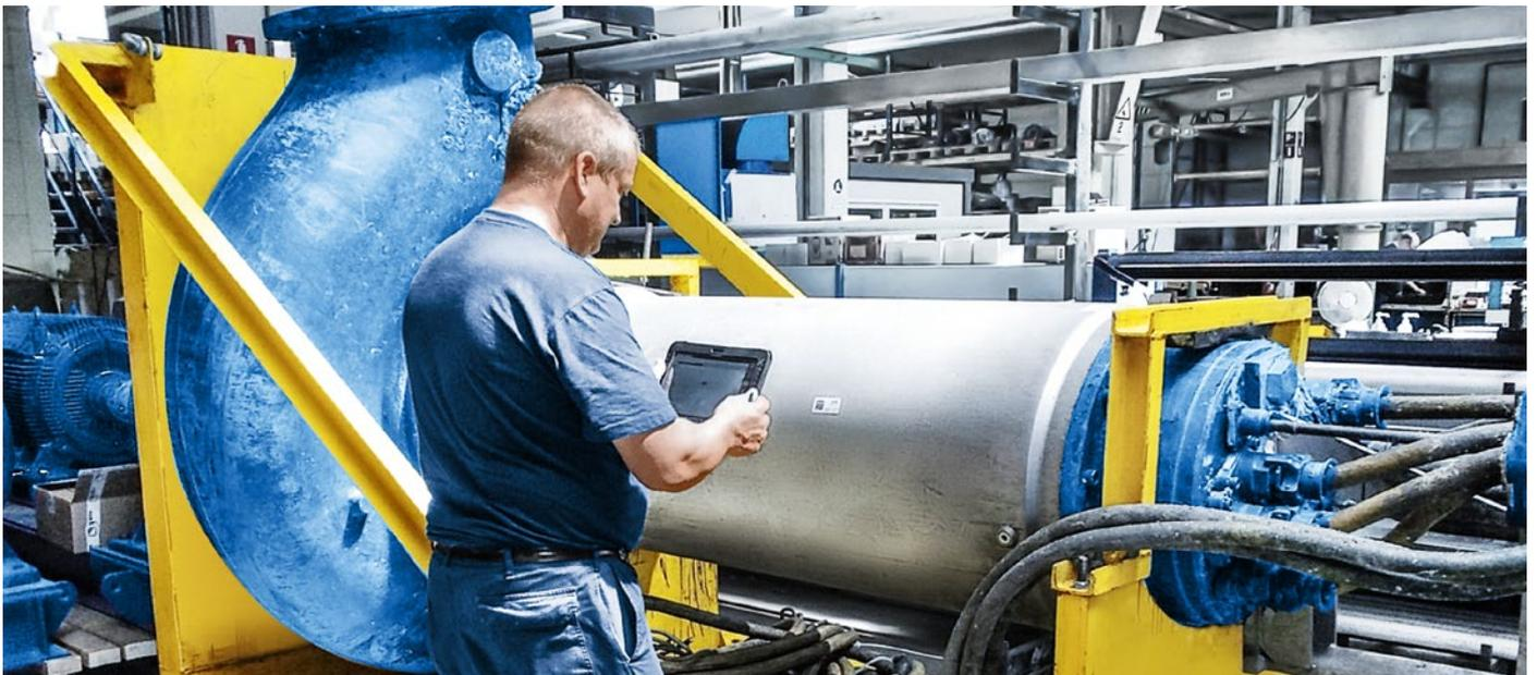
Schneller und einfacher Zugriff auf Pumpendaten mit KSB Equipment Management: Per QR-Code am Aggregat werden die Daten auf dem Tablet im Browser dargestellt.
